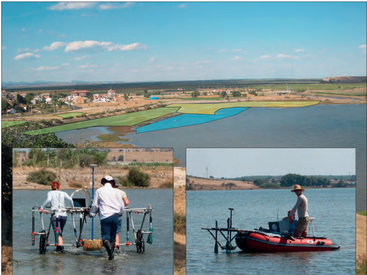
Abb. 1 Potenzieller Hafenbereich im Norden der östlichen Lagune. Der grüne Bereich markiert die Landmessungen, der gelbe den amphibischen Bereich und der blaue den marinen Bereich, in dem magnetische Messungen durchgeführt wurden. Die unteren Fotos zeigen die amphibischen Messungen mit einem Handwagen und die Messungen mit einem Schlauchboot. – (Fotos S. Spletstößer, CAU Kiel).
